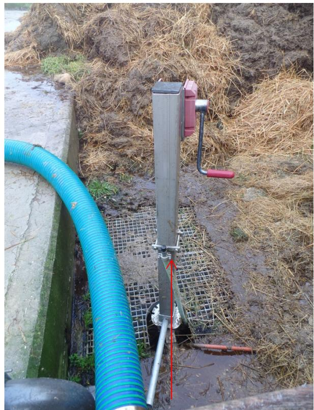
*Tauchschneidpumpe mit Schlauch und Injektor*
