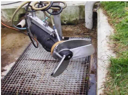
Abbildung 3: Güllebelüftung Samuel Otti
